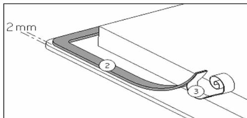
Fastgør tætningslisten (2) to millimeter fra glassets yderkant – efter De har fjernet den beskyttende papiroverflade (3)
